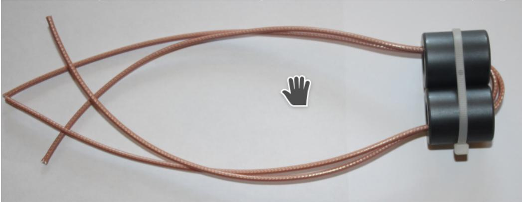
Man bindet zuerst die beiden Kerne mit Kabelbinder zusammen. Dann steckt man das (doppelte) RG-316 durch den Kern.
